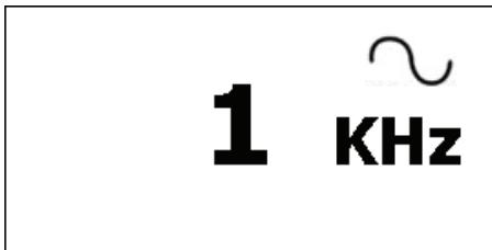
(1) 波形選擇：按 **WAVE⑫** 鍵，波形將以圖形顯示於螢幕上。
